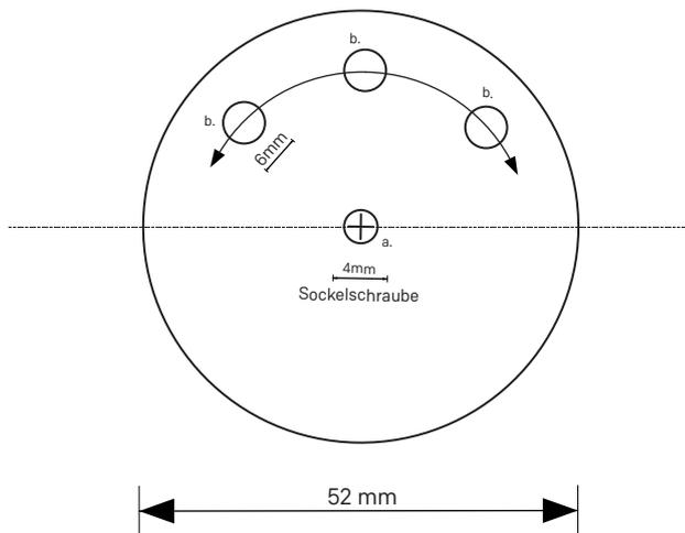
Die Durchführung für das Kabel irgendwo in der oberen Hälfte, über der Sockelschraube, innerhalb des Sockels bohren.
