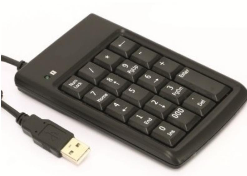
Sie können einen USB Nummernblock an einen der USB Ports des Molitor MP 02 4K anschließen.
